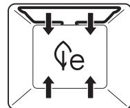
Данный режим работы особенно энергосберегающий. Нагрев осуществляется с помощью верхних и нижних нагревательных элементов. Влага, выделяемая продуктом, остается в камере. Приготовляемое блюдо не пересыхает.
