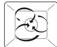
Воздух в камере нагревается нагревательным элементом, расположенным за задней стенкой камеры, и равномерно циркулирует.
